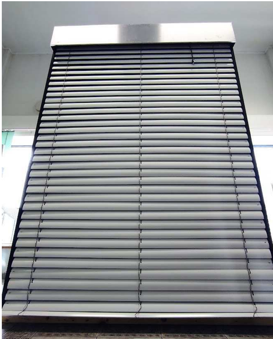
Rys. 9. Próbką zamontowana na ramie badawczej.
