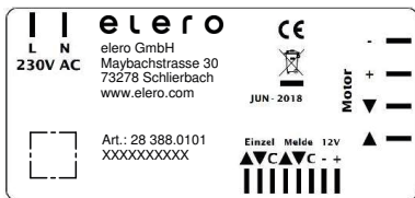
Rys. 2: Tabliczka znamionowa modułu sterującego
