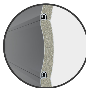
Profilé de volet roulant en aluminium rempli de mousse de polyuréthane
